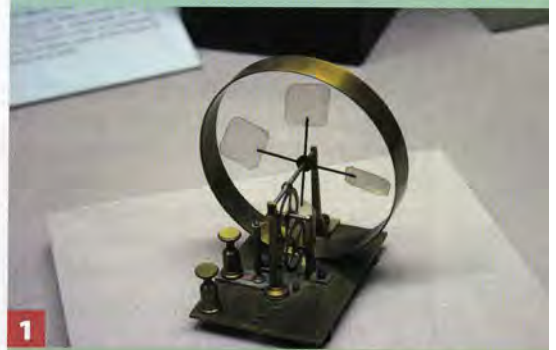
1 Modèle d'anémomètre à pales, construit par un fabricant espagnol (J. Graselli), daté de 1870.
